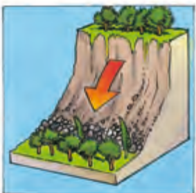
ÉBOULEMENT CHUTE DE BLOCS (DÉPLACEMENT RAPIDE)
