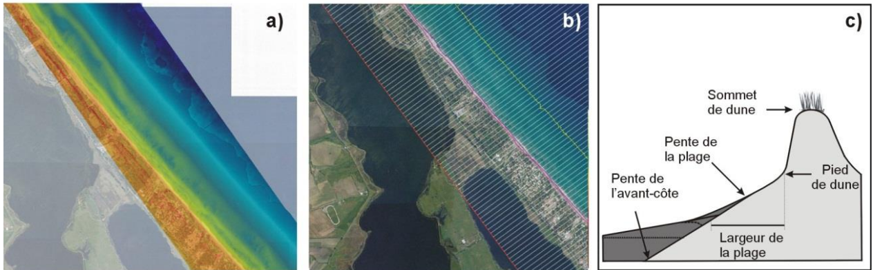
Illustration 8 – Utilisation du levé Lidar pour le calcul des variables morphologiques : a) extrait du modèle numérique de terrain ; b) discrétisation du littoral tous les 50 m et ; c) variables morphologiques utilisées (Balouin et al., 2011).
