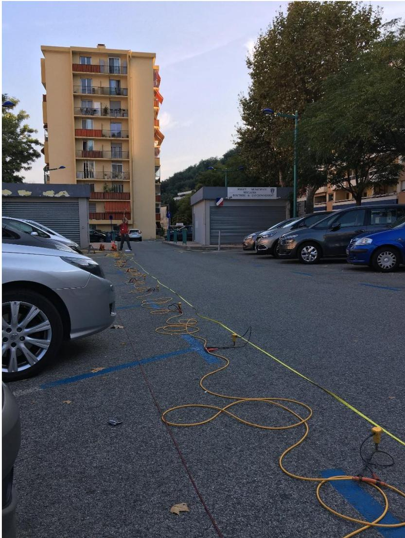
*Figure 31 : Photo du profil MASW « parkingcaréi » réalisé sur un parking dans la vallée du Caréi le 15/09/2020.*
