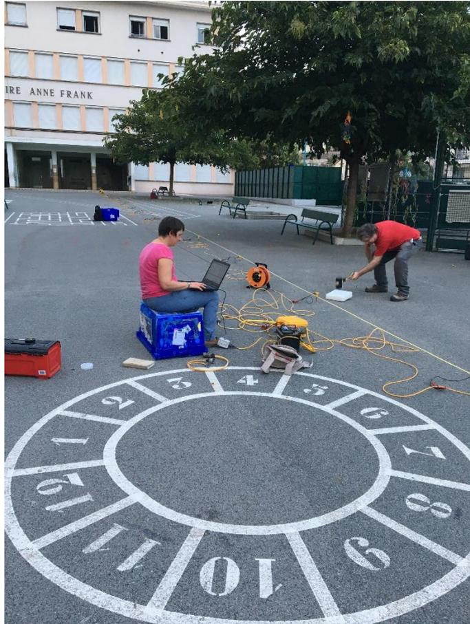
*Figure 8 : Photo illustrant le dispositif de mesures sismiques utilisé. Agathe Roullé contrôlant la Géode avec le PC au centre du dispositif de 24 traces (intertrace 3 m) et Mickael Delatre au tir n°4. Profil réalisé à l'école Anne Frank.*
