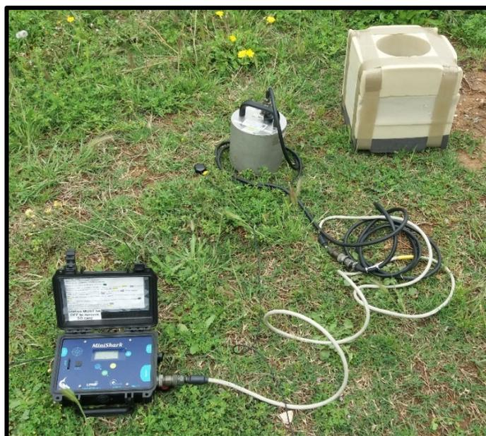
Figure 12 : Dispositif de mesure du bruit de fond sismique.
